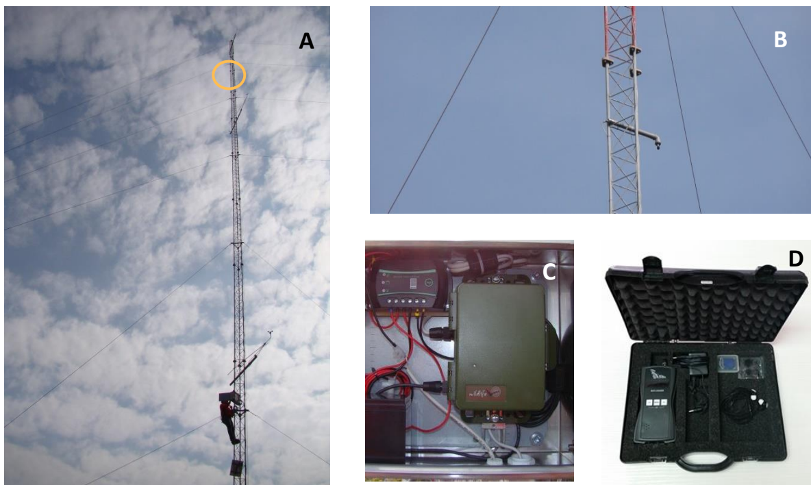
Slika 3. Oprema za praćenje aktivnosti šišmiša na lokaciji planirane VE Dazlina: A – mjerni stup i označen položaj mikrofona, B – mikrofoni uz mjerni stup na istraživanoj lokaciji, C – ultrazvučni detektor SM4BAT FS Song Meter za kontinuirano praćenje, D – Elekon Batlogger M za periodično praćenje (Foto: G. Rnjak, D. Rnjak, N. Hanžek)
