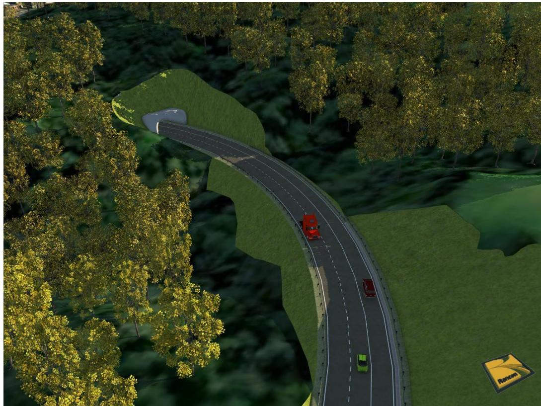
Sl. 1.4-3. Varijanta 1 – izlaz iz tunela duljine cca  $L=250m$  s usjekom
