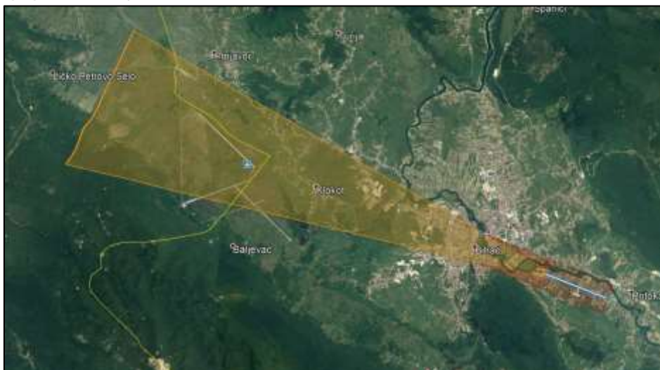
Slika 14. Prilazna ravan praga 12
