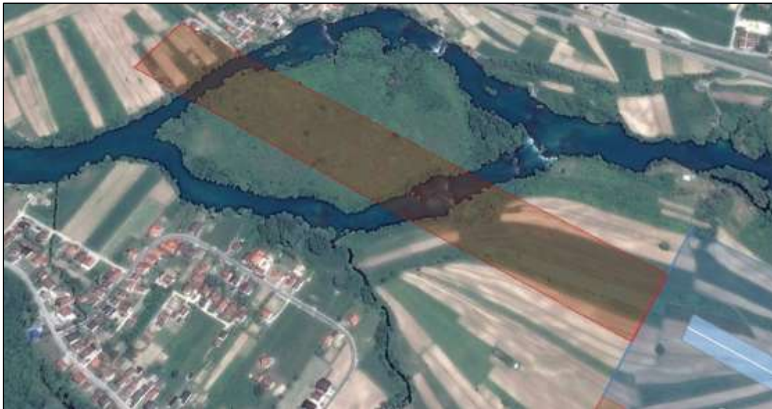
Slika 11. Unutrašnja prilazna površina praga 12
