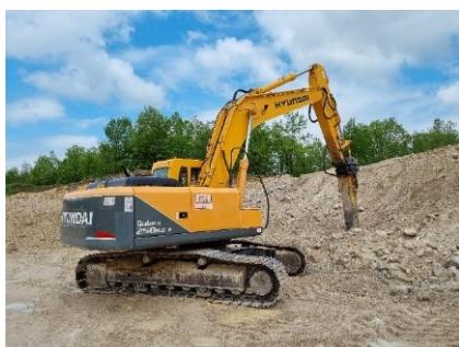
d) Hidraulični bager s čekićem
