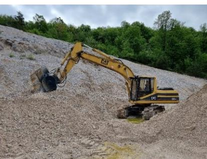
e) Hidraulični bager s montažnom čeljusnom drobilicom
