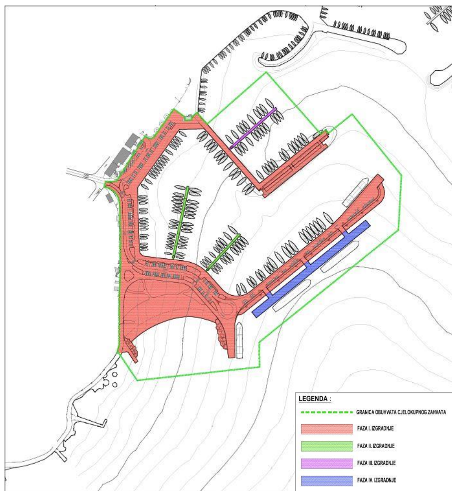
Slika 3. Faze izgradnje predmetnog zahvata (I.-IV.)
