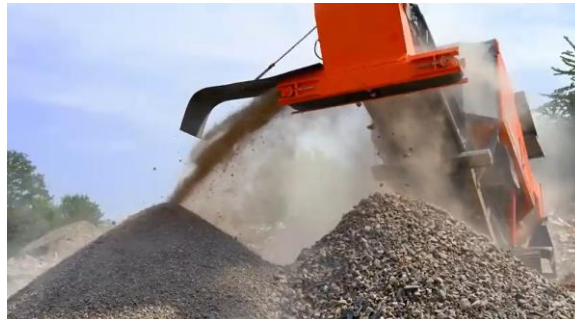
Slika 4.1-1: Emisije prašine višenamjenske drobilice materijala pri drobljenju građevnog otpada
