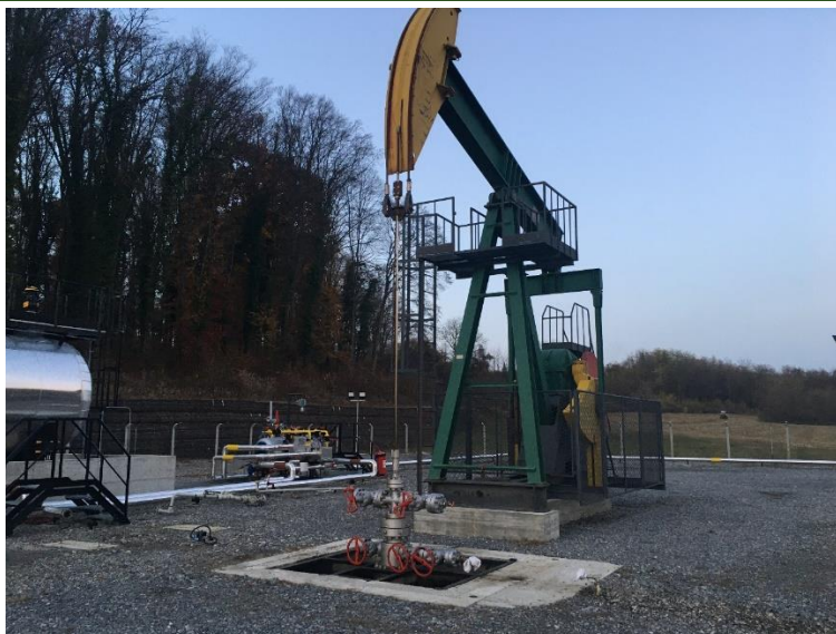
Grafički prikaz A-6: Primjer bušotine s njhalicom
