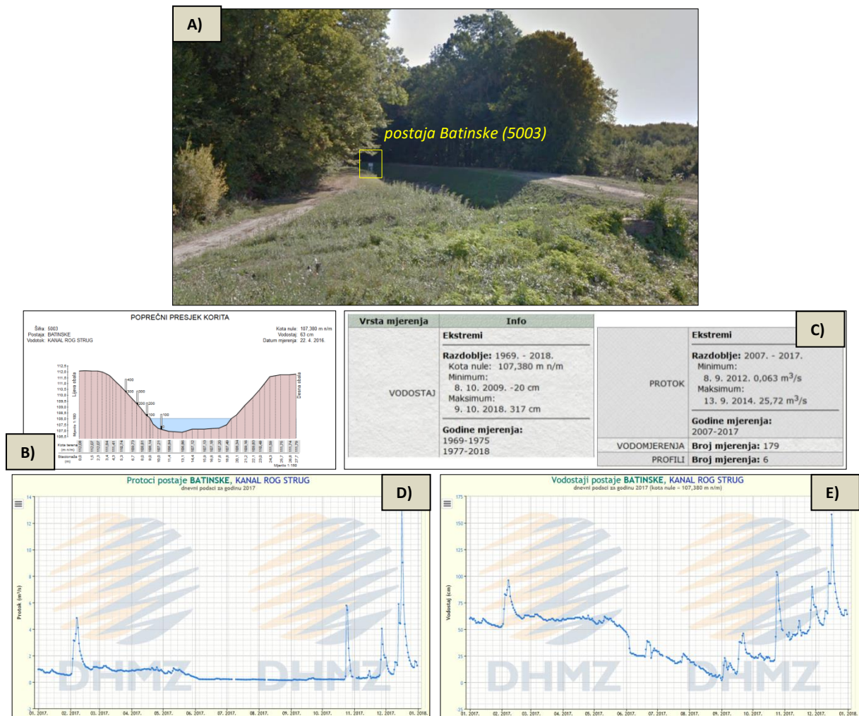
Slika 19. Automatska dojava Batinske (šifra 5003) na kanalu Rog Strug (A), poprečni presjek korita (B), podaci o izmjenjenim ekstremima na postaji (C), posljednji (2017) objavljeni podaci o protoku (D) i vodostaju (E) (Izvor: Sektor za hidrologiju, DHMZ, https://hidro.dhz.hr/ )
