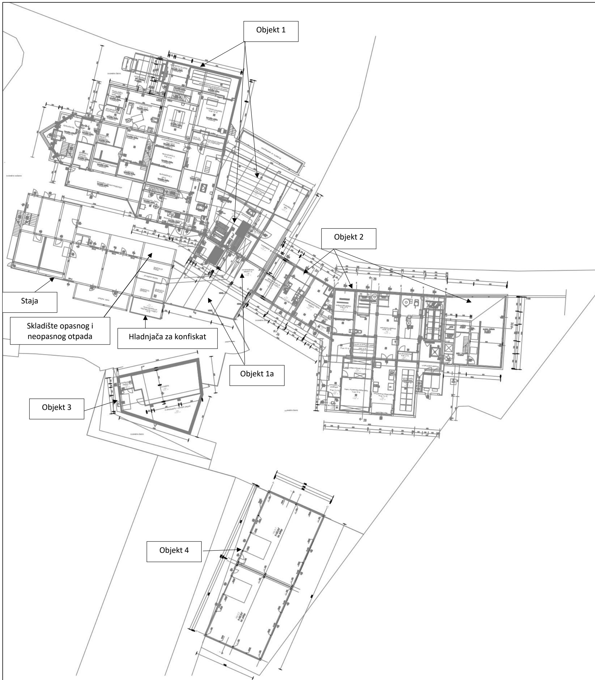
Slika 7. Tlocrt prizemlja postojećih objekata postrojenja Vugrinec d.o.o. izgrađenih sukladno Rješenju o izmjeni i dopuni građevinske dozvole od 21.11.2018. godine (izvor: Glavni projekt, Arhitektonsko-građevinski projekt, ARMONT d.o.o., 2016)
