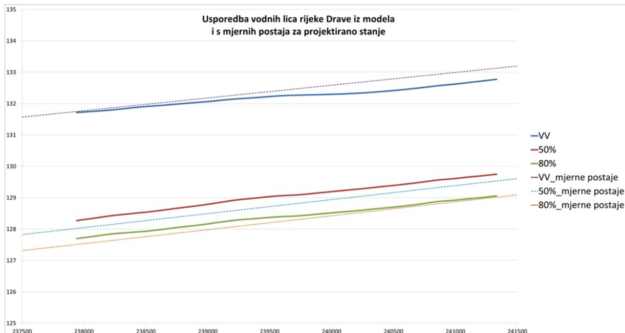
**Slika 4-34.** Usporedba vodnog lica rijeke Drave iz modela projektiranog stanja pri velikoj vodi (VV), vodi 50%-tnog i 80%-tnog trajanja s vodnim licima dobivenim s mjernih postaja Donja Dubrava i Botovo
