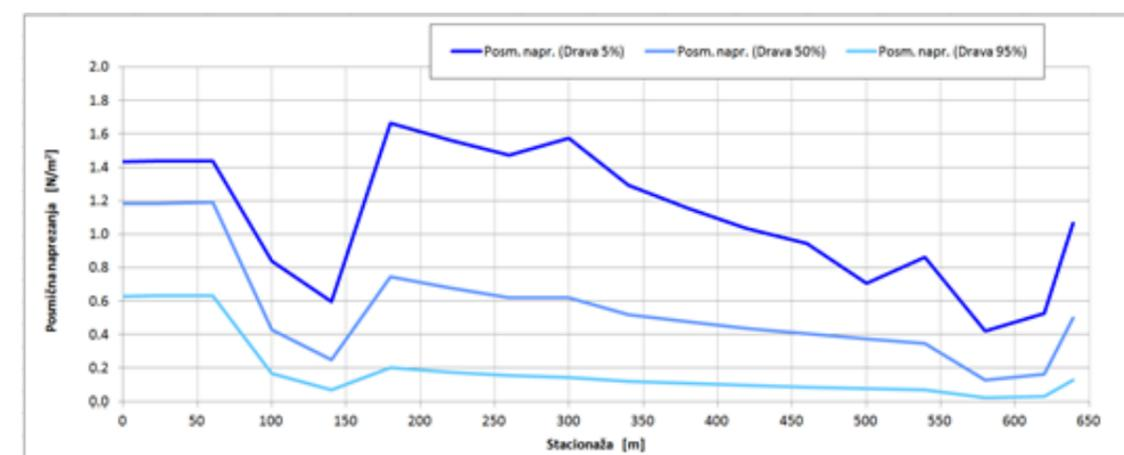
Slika 4-88. Prikaz rezultata proračuna posmičnih naprezanja u koritu na uzdužnom profilu prokopa za var. 3b
