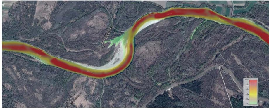
Slika 4-42. Raspored posmičnih napreznja za vodu 80%-tnog trajanja na lokaciji C.3 (post. stanje)
