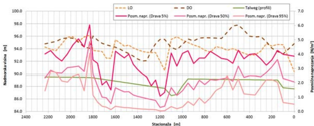
**Slika 4-82.** Prikaz rezultata proračuna posmičnih naprezanja u koritu na uzdužnom profilu rukavca C.6 za var. 3a
