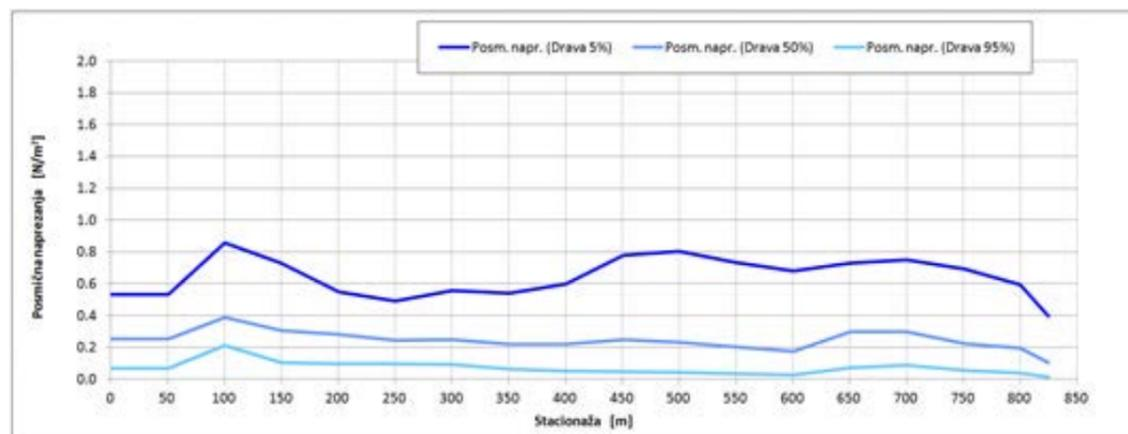
Slika 4-85. Prikaz rezultata proračuna posmičnih naprezanja u koritu na uzdužnom profilu rukavca C.6 za var. 3b
