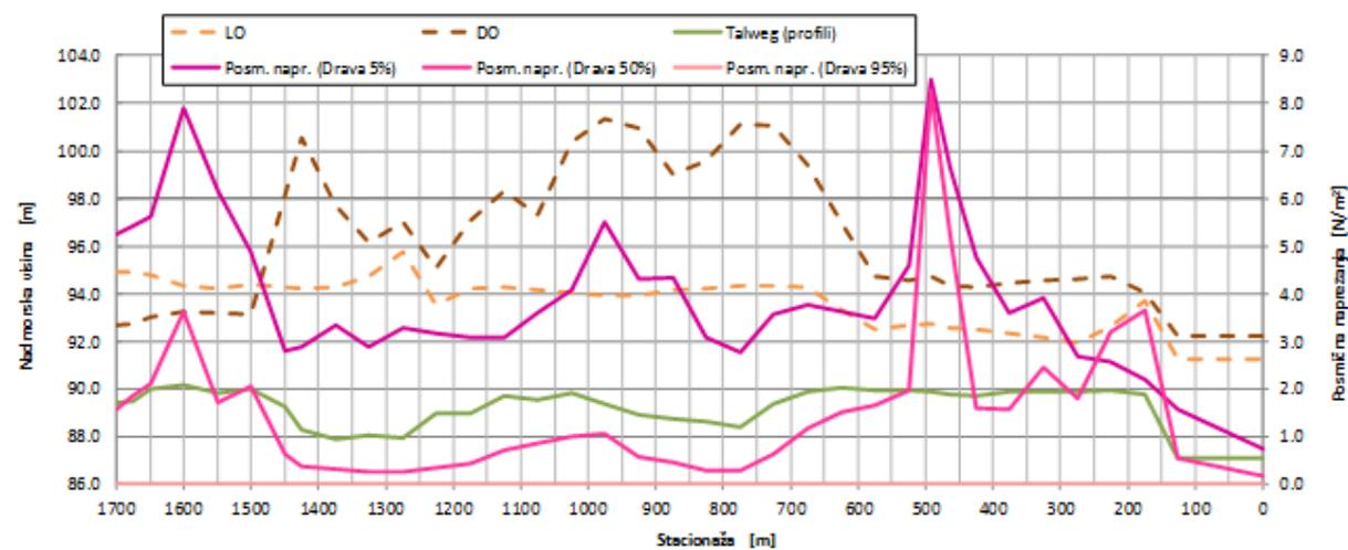
**Slika 4-91.** Prikaz rezultata proračuna posmičnih napreznja u koritu na uzdužnom profilu rukavca C.7 za postojeće stanje
