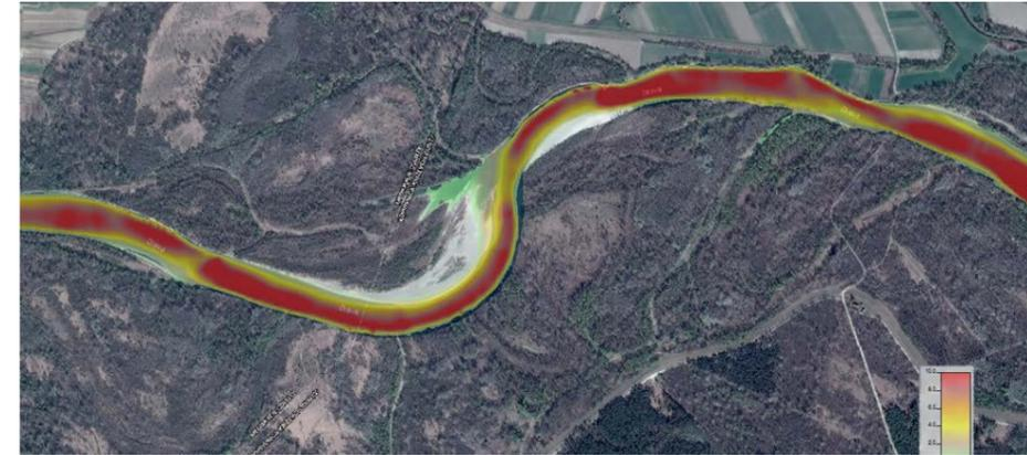
Slika 4-45. Raspored posmičnih napreznja za vodu 80%-tnog trajanja na lokaciji C.3 (proj. stanje)
