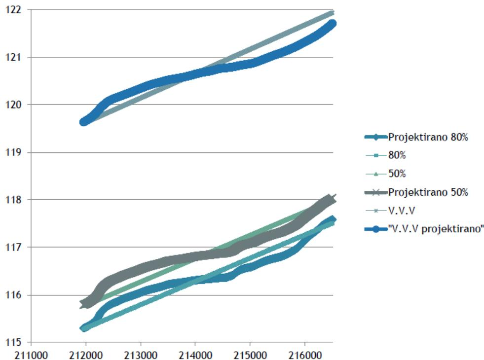
**Slika 4-64.** Usporedba vodnog lica rijeke Drave iz modela projektiranog stanja pri velikoj vodi (VV), vodi 50%-tnog i 80%-tnog trajanja s vodnim licima dobivenim s mjernih postaja Botovo i Novo Virje Skela
