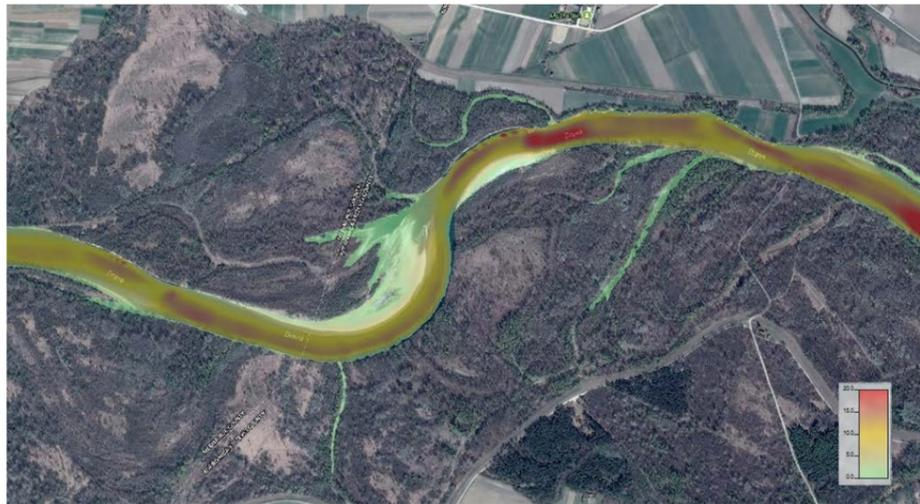
Slika 4-43. Raspored posmičnih napreznja za vodu 50%-tnog trajanja na lokaciji C.3 (post. stanje)
