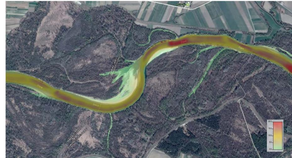
Slika 4-46. Raspored posmičnih napreznja za vodu 50%-tnog trajanja na lokaciji C.3 (proj. stanje)
