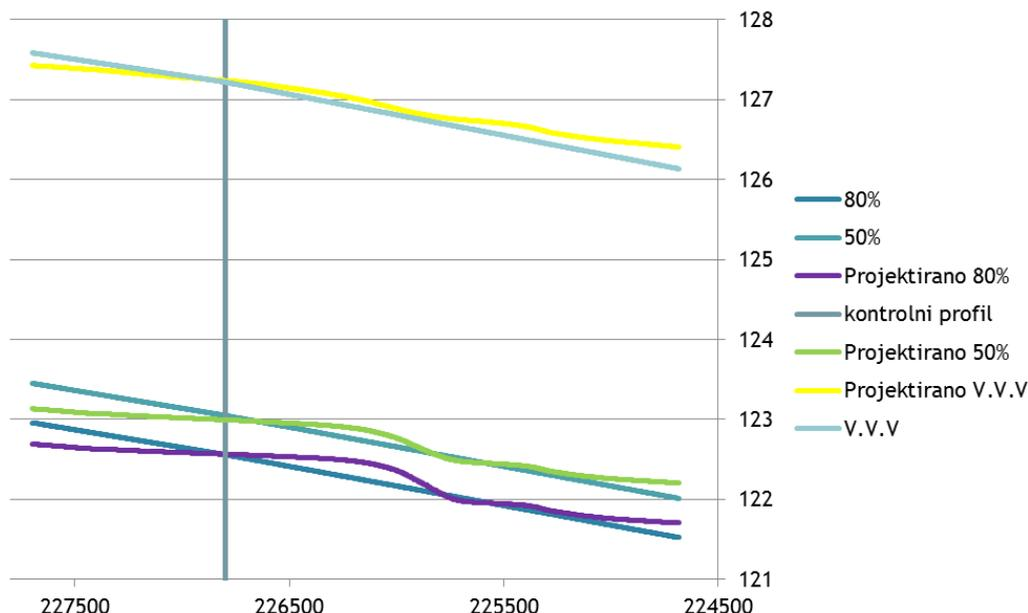
**Slika 4-52.** Usporedba vodnog lica rijeke Drave iz modela projektiranog stanja pri velikoj vodi, vodi 50%-tnog i 80%-tnog trajanja s vodnim licima dobivenim s mjernih postaja Donja Dubrava, Botovo i Novo Virje Skela
