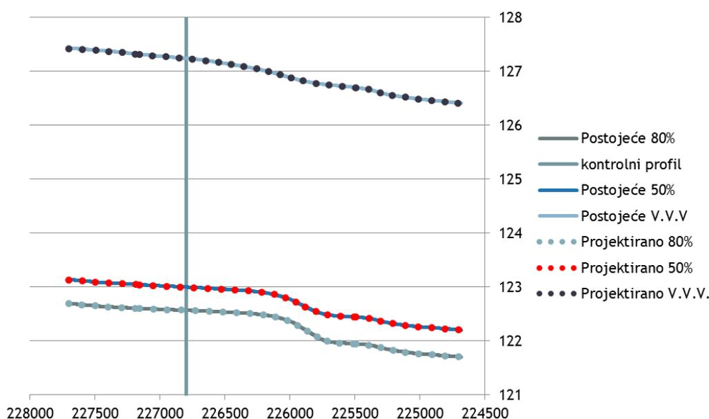
**Slika 4-53.** Usporedba vodnog lica rijeke Drave iz modela postojećeg stanja sa vodnim licem modela projektiranog stanja pri velikoj vodi, vodi 50%-tnog i 80%-tnog trajanja
