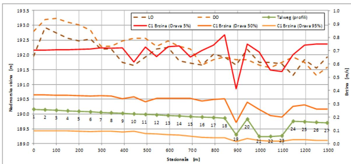
Slika 4-7. Prikaz rezultata proračuna brzina na uzdužnom profilu rukavca C.1 za var. 2
