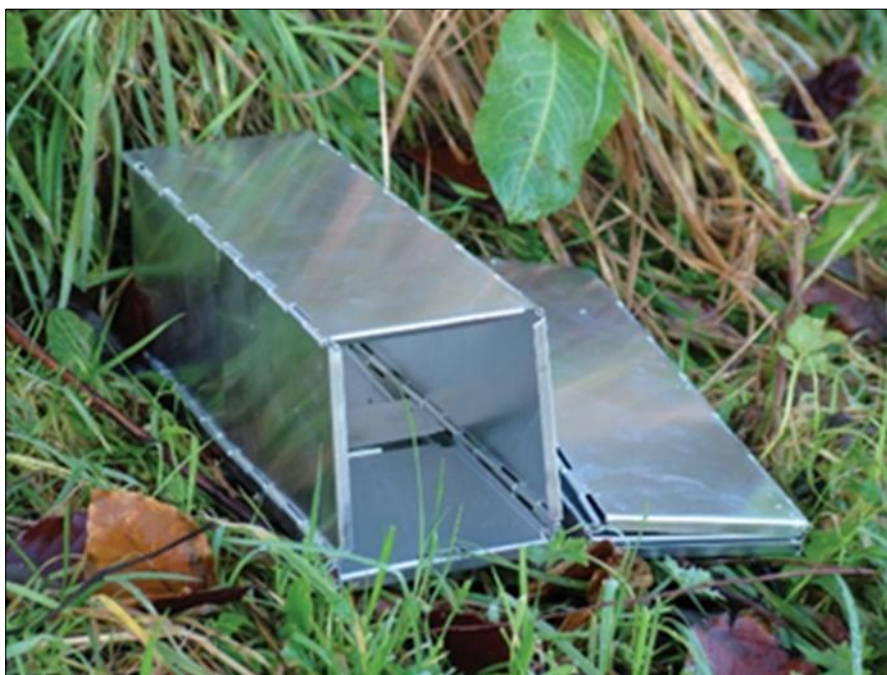
Slika 1.2-1 Aluminijska živolovka tipa Sherman korištena za utvrđivanje prisutnosti dinarskog voluhara (Izvor: nhbs.com)
