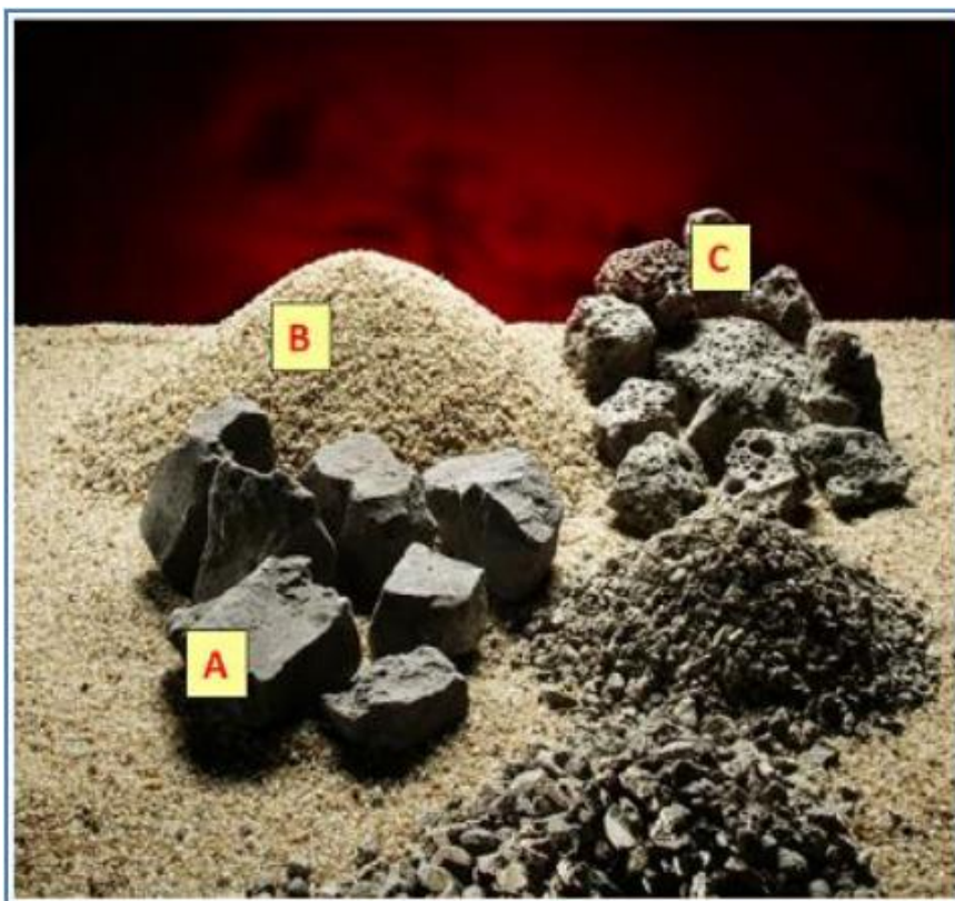
Slika 5: Troska iz visoke peći a) zrakom hlađena, b) granulirana i c) ekspandirana
