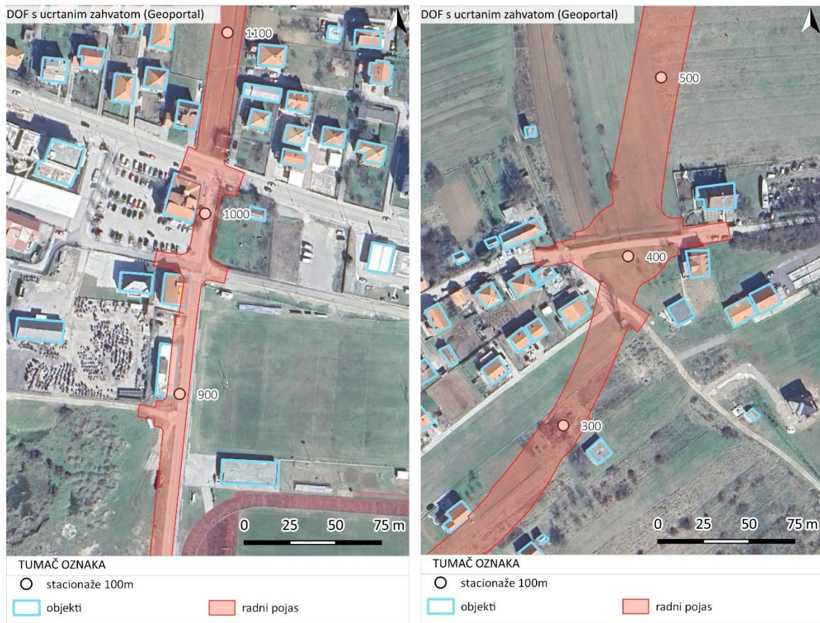
Grafički prikaz D-3: Trasa zahvata s prikazanim objektima na području radnog pojasa zahvata
