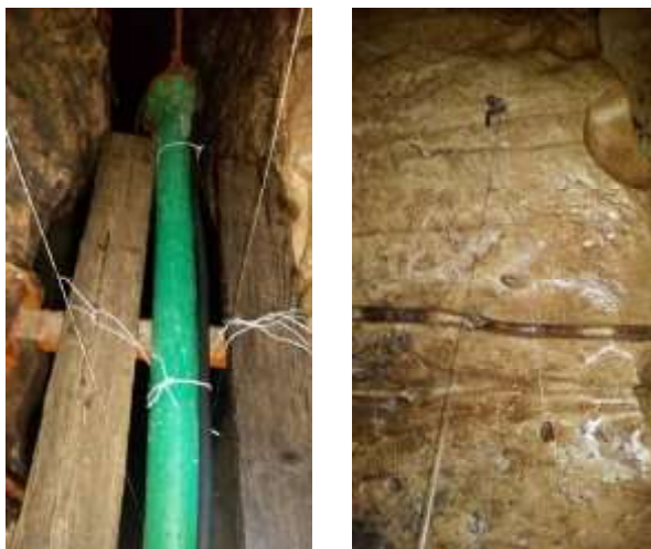
Fotografija D-1: Sajle s ugrađenim loggerima
