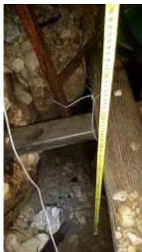
Fotografija D-2: Mjerenje dubine ugradnje loggera
