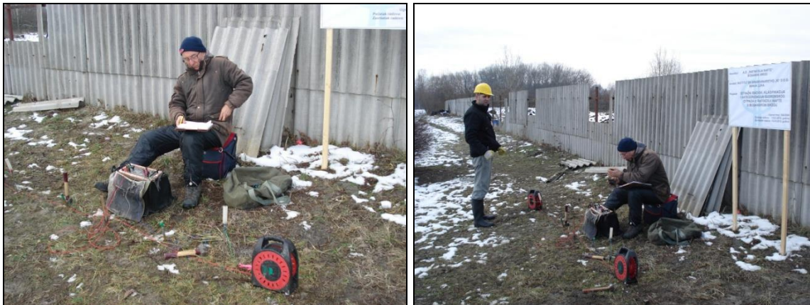
Slika 10. Terenska geofizička ispitivanja lokacije odlagališta gudrona
