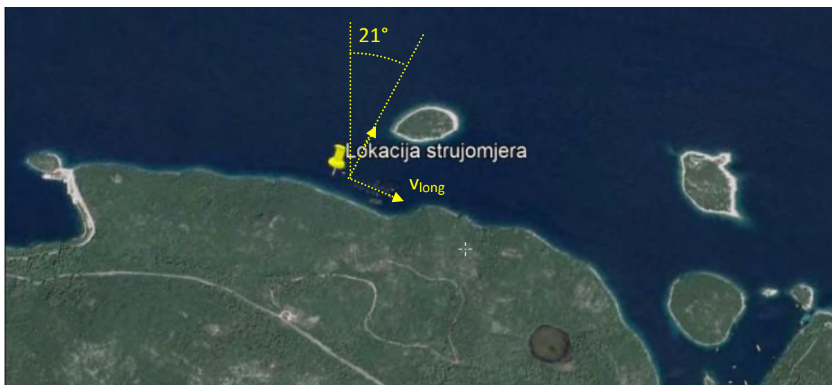
Slika 66. Razdvajanje komponenti brzina struja u smjeru ( v_{long} ) i okomito ( v_{trans} ). Smjer brzine v_{long} je 111^\circ u odnosu na sjever (smjer kazaljke na satu).
