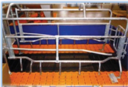
Slika 8. Boks s uklještenjem za krmaču
