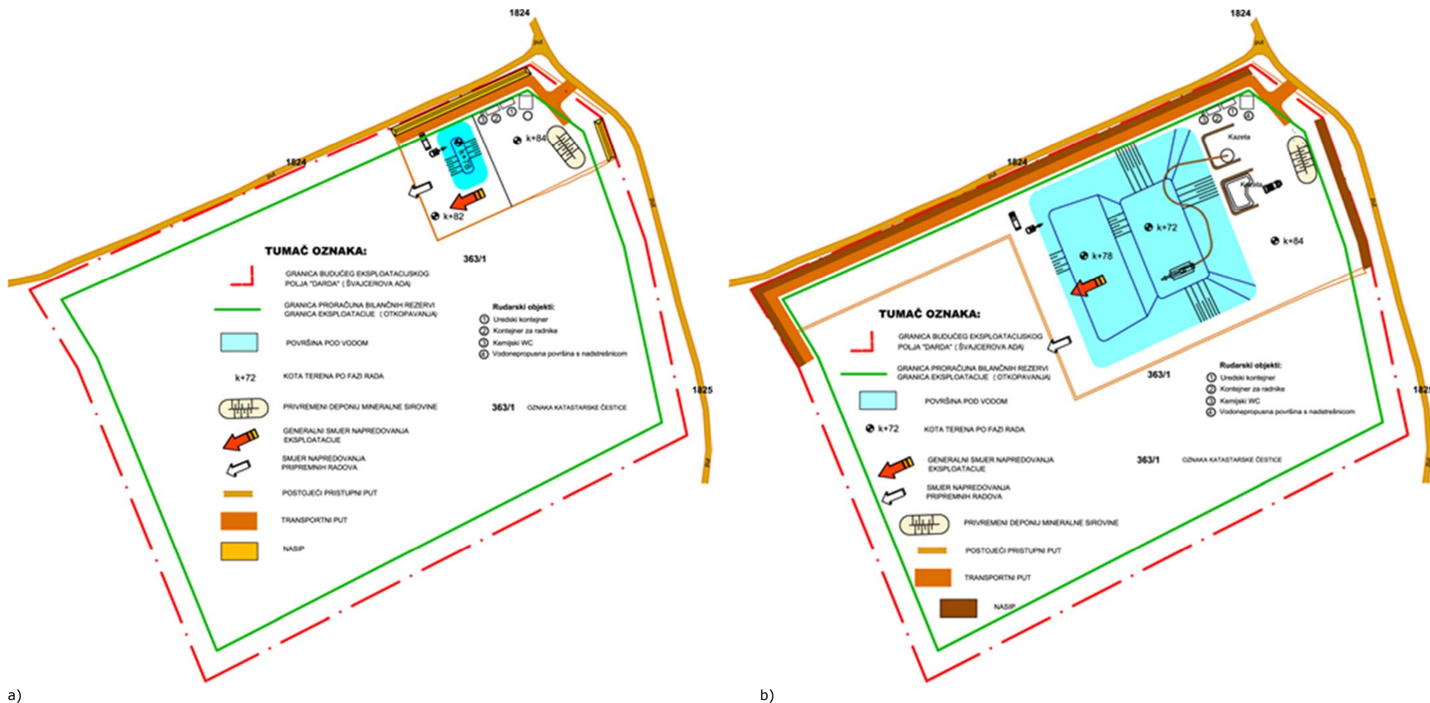
Slika 24. Varijanta 1 otvaranja kopa u smjeru - i pripremnih radova (a) eksploatacija hidrauličnim bagerom s obrnutom lopatom, b) otvaranje veće površine za rad usisnog bagera)
