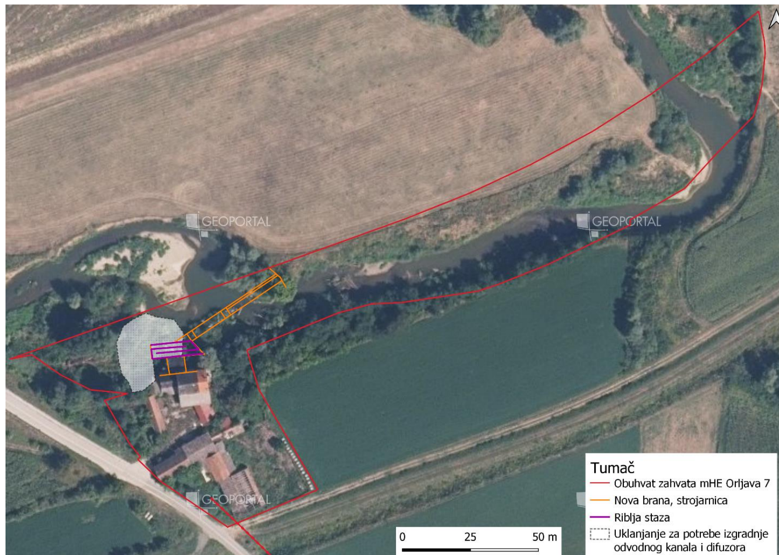
Slika 2.10 Prikaz elemenata zahvata i područja uklanjanja riječnih nanosa
