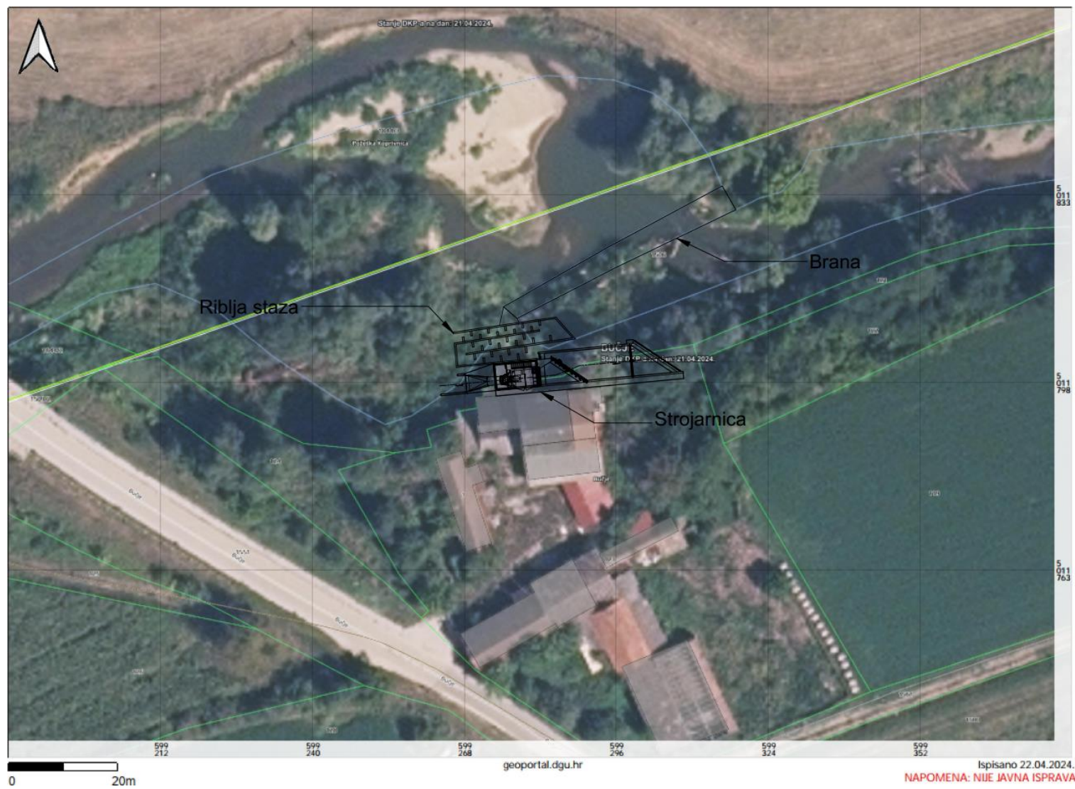
Slika 2.7 Shematski prikaz riblje staze
