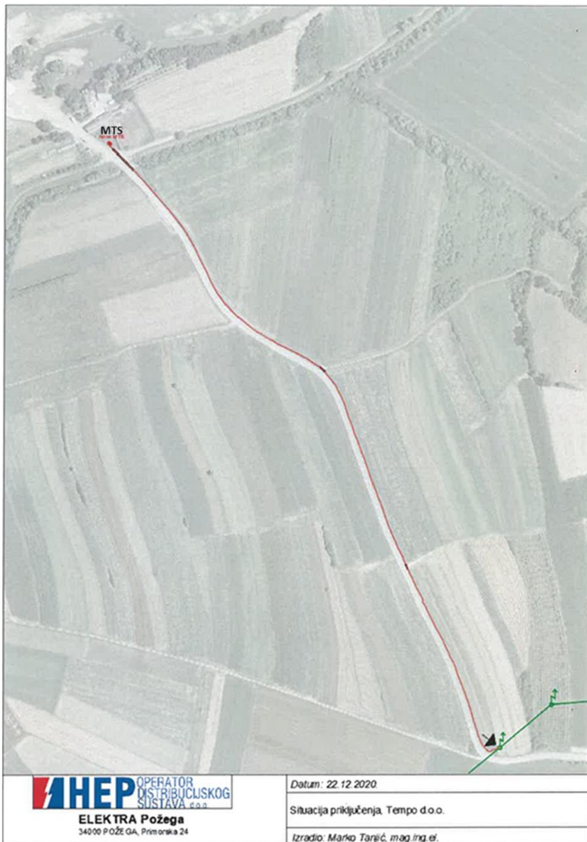
Slika 2.11 Preslika skice priključka građevine (crvena linija) na mjernu trafostanicu (MTS) 10(20)/0,4kV Bučje-2 i distribucijsku mrežu (zelena linija)
