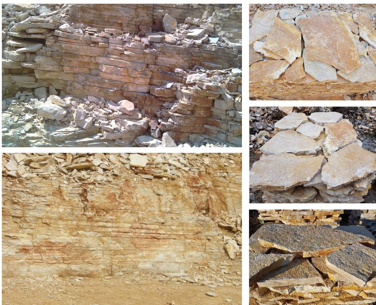
**Slika 2-12.** Tankopločasti vapnenac – u stijenskoj masi i otkopane ploče kamenja
