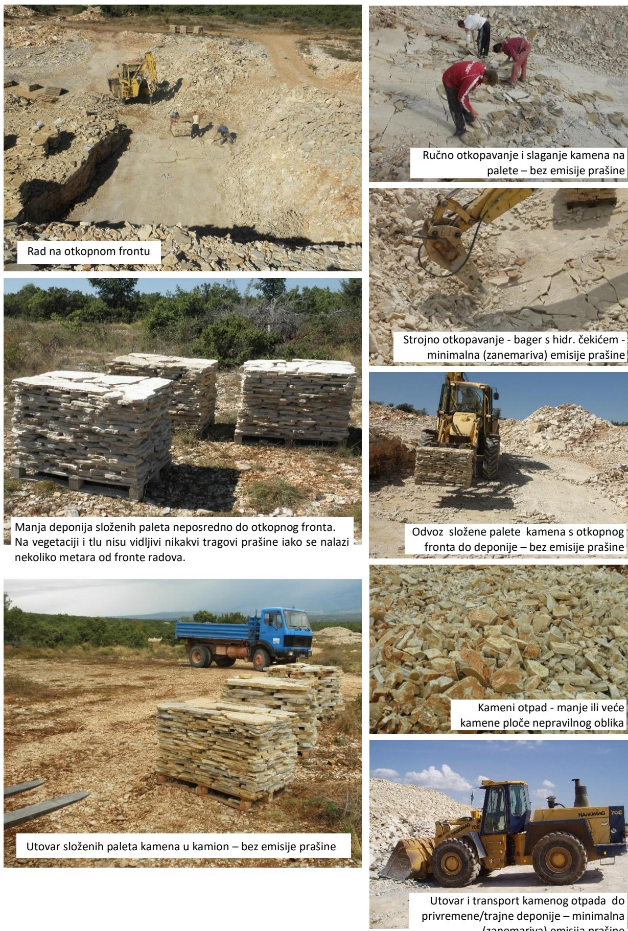
**Slika 5-1.** Tehnološki proces eksplotacija "benkovačkog arhitektonskog kamena" – bez emisije prašine ili s njenim minimalnim produciranjem – fotoprimeri iz prakse
