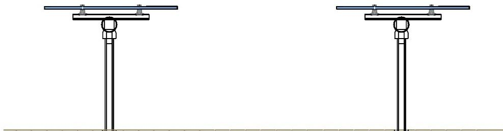
Slika 1.2-1 Načelni prikaz konstrukcija s jedno-osnim zakretnim sustavom
