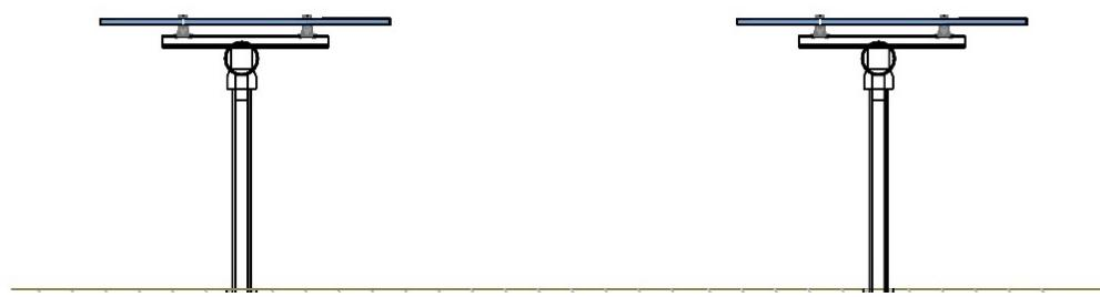
Slika 2.1-4 Načelni prikaz konstrukcija s jedno-osnim zakretnim sustavom
