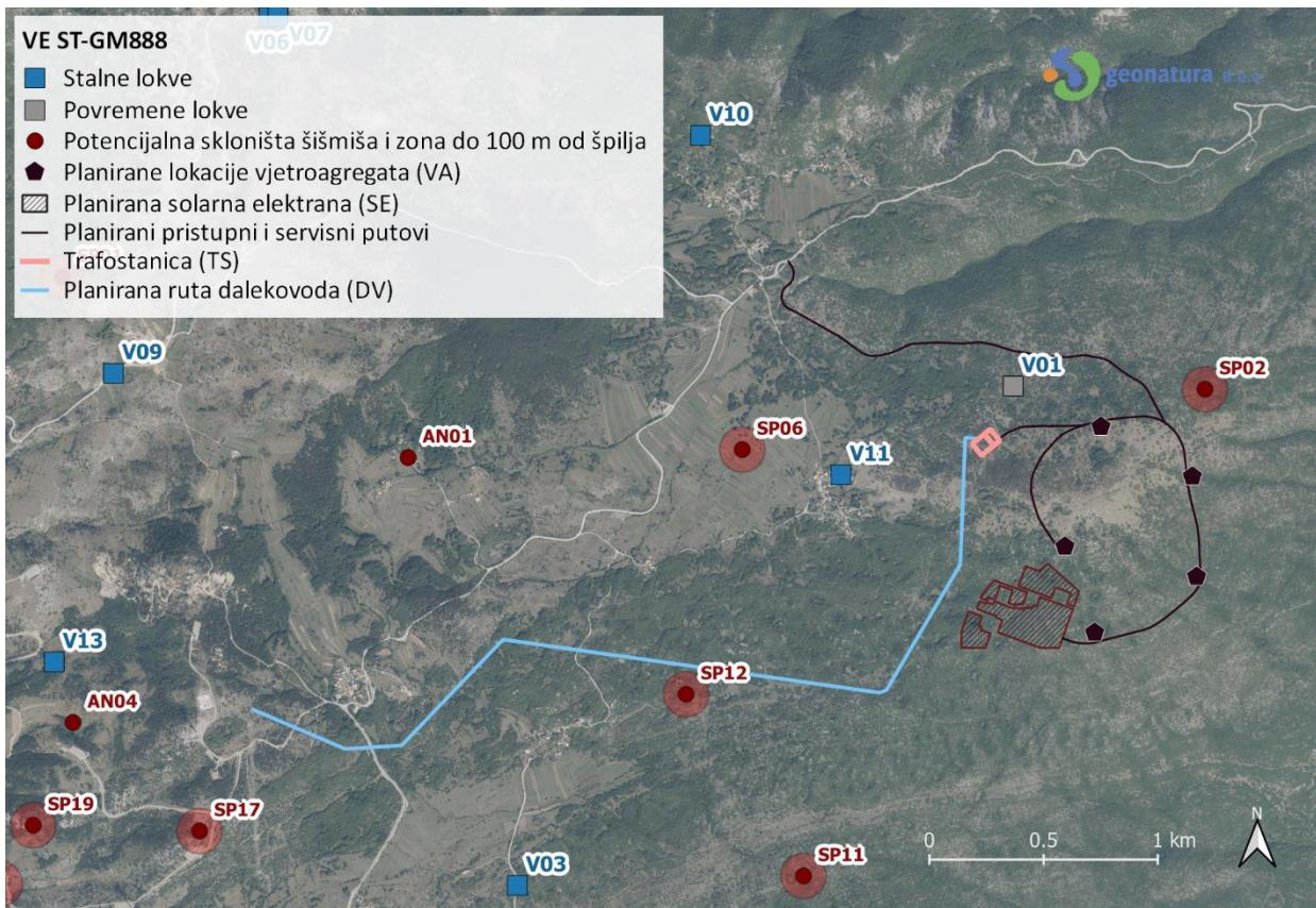
**Slika 5.5-4 Završno idejno rješenje planirane VE i SE ST-GM888 u odnosu na lokacije istraženih potencijalnih skloništa šišmiša i otvorenih slatkvodnih površina**
