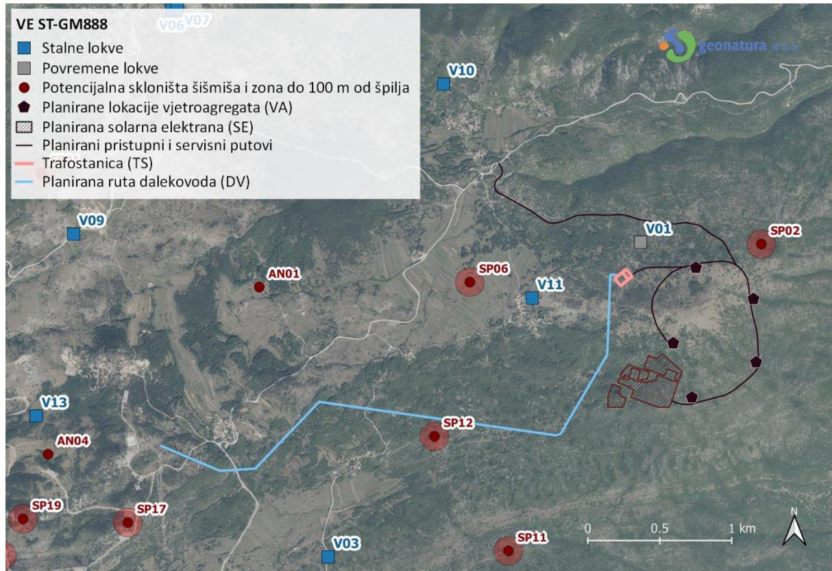
Slika 53. Završno idejno rješenje planirane VE i SE ST-GM888 u odnosu na lokacije istraženih potencijalnih skloništa šišmiša i otvorenih slatkovodnih površina
