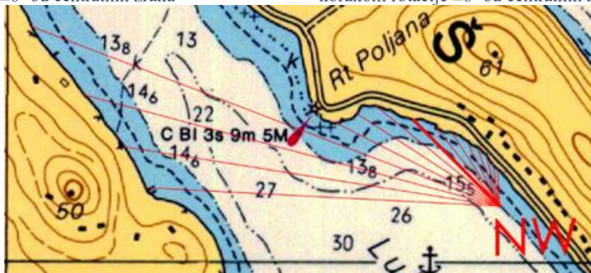
Slika 2.23. Centralne zrake kroz smjer NW te zrake sa korakom rotacije \pm 6^\circ od centralnih zraka
