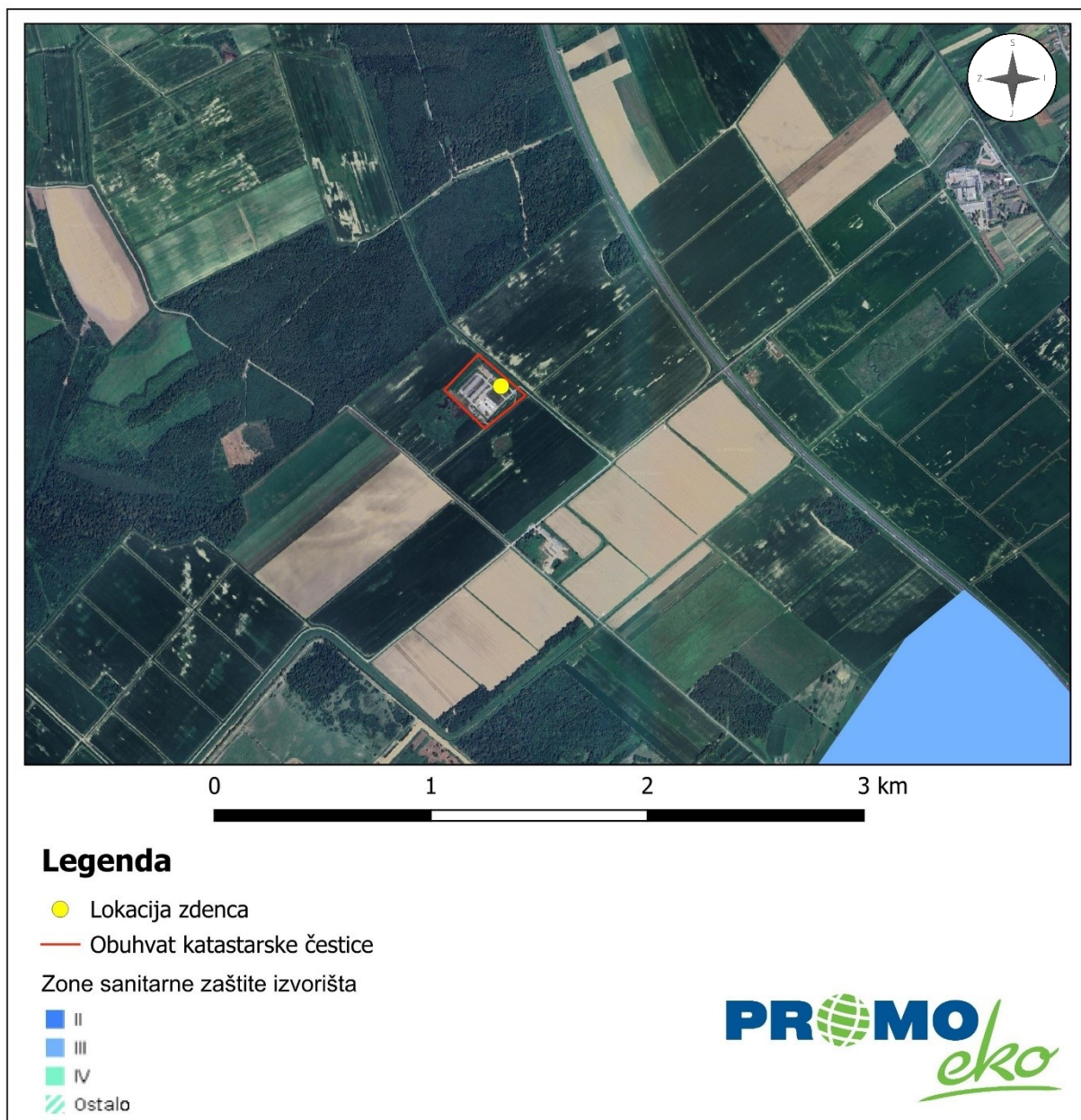
Slika 11. Izvod iz kartografskog prikaza zona sanitarne zaštite izvorišta (Izvor: Geoportal Hrvatskih voda)
