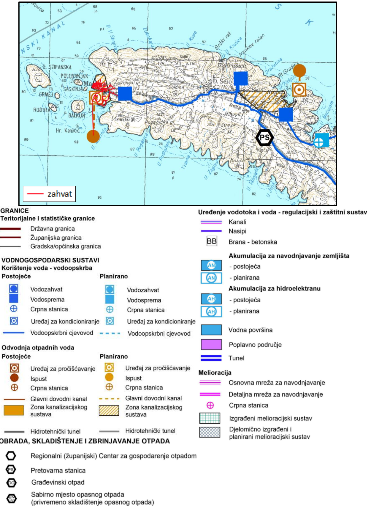
Slika 3.2.1-1. Izvod iz PPSDŽ: dio kartografskog prikaza oznake 2. Infrastrukturni sustavi, 2.3. Vodnogospodarski sustavi, obrada, skladištenje i zbrinjavanje otpada, s preklapljenim zahvatom
