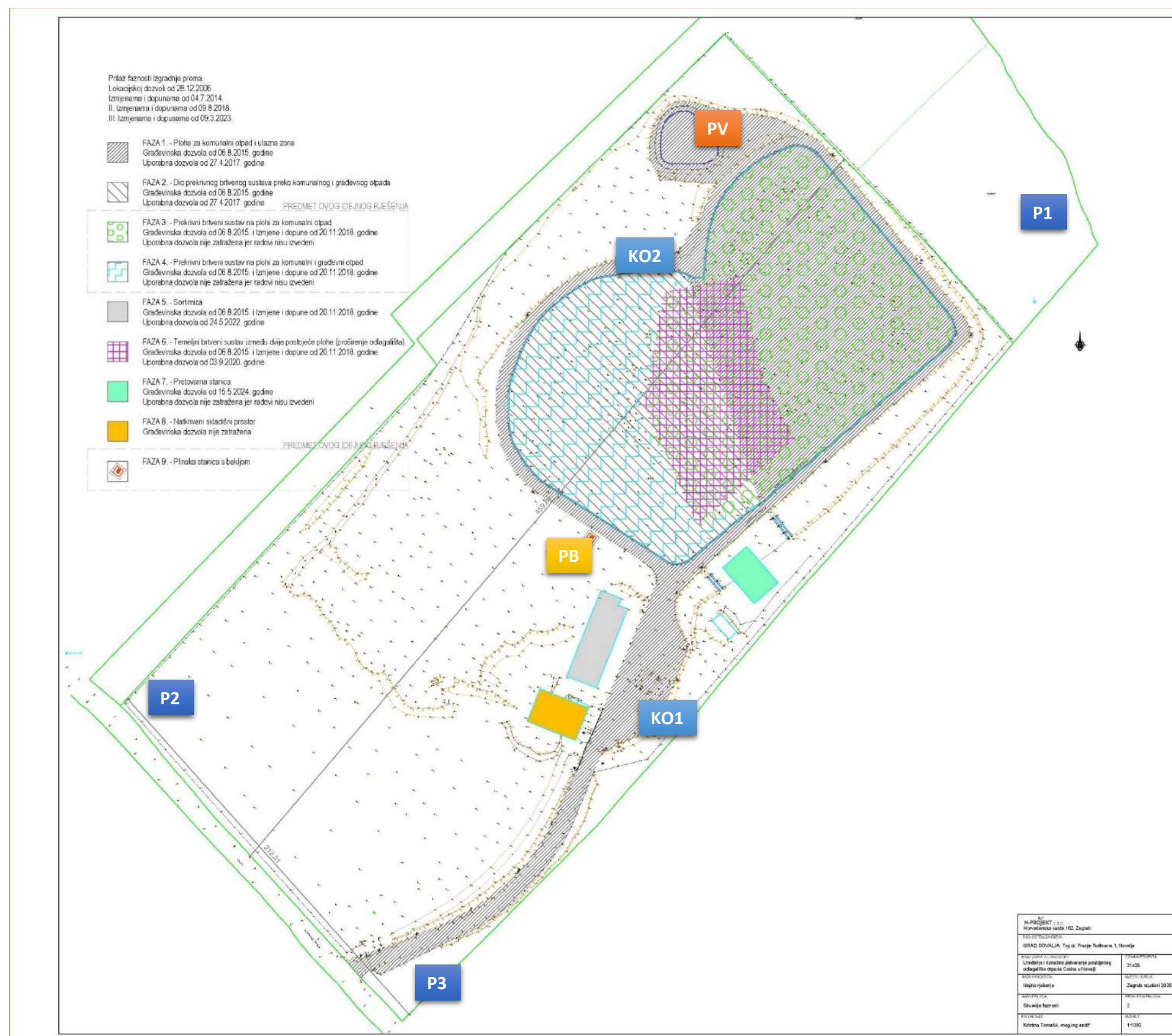
Slika 12 Predložena mjesta uzorkovanja: KO1 i KO2 (oborinske vode), PV (procjedna voda), P1 (uzvodni pijezometar), P2 i P3 (nizvodni pijezometri), PB (plinska baklja)
