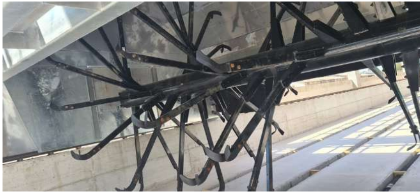
Slika 13. Primjer noževa za miješanje i usitnjavanje materijala u fermentoru (Izvor: Kohshin Ltd.)
