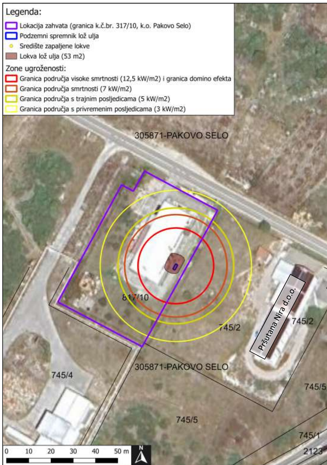
Slika 46. Najgori mogući slučaj za izlivanje lož ulja iz autocisterne (vrijeme izlivanja 15 sekundi), njegovog zapaljenja te maksimalni doseg posljedice nesreće unutar i izvan lokacije zahvata
