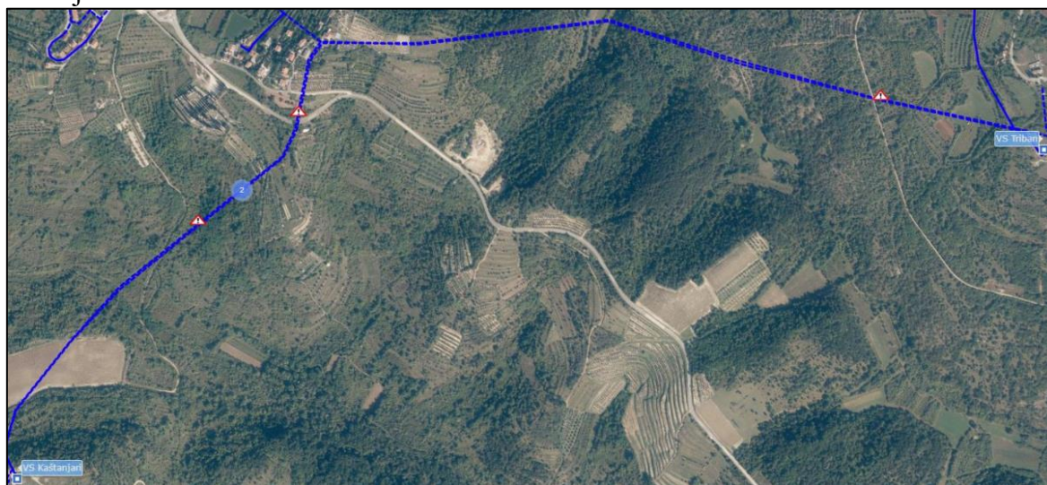
Slika 9. Lokacije kvarova na cjevovodu VS Triban – VS Kaštanjari
