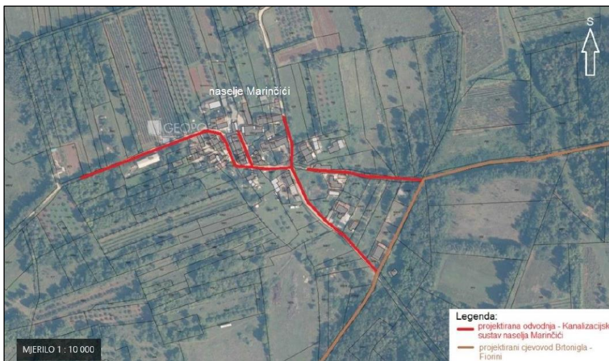
Slika 20. Prikaz planiranog kanalizacijskog sustava naselja Marinčići
