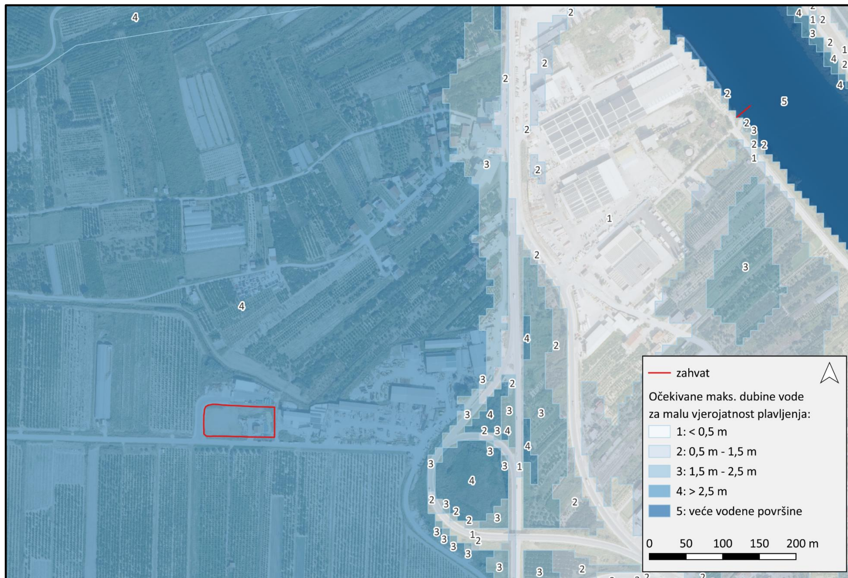
Slika 3.1.5-6. Očekivane maksimalne dubine vode za poplave male vjerojatnosti za područje zahvata (izvor: Hrvatske vode, 2019.)
