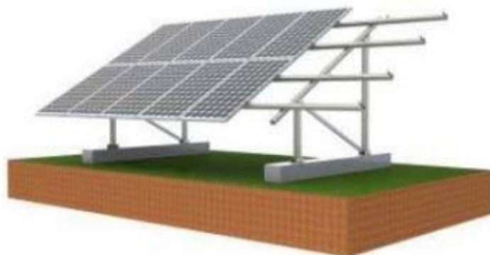
Slika 2.2-11 Nosač fotonaponskog modula (Izvor: Idejni elaborat „Fotonaponska elektrana za vlastite potrebe“, TENSOR PROJEKT d.o.o., studeni 2024.)
