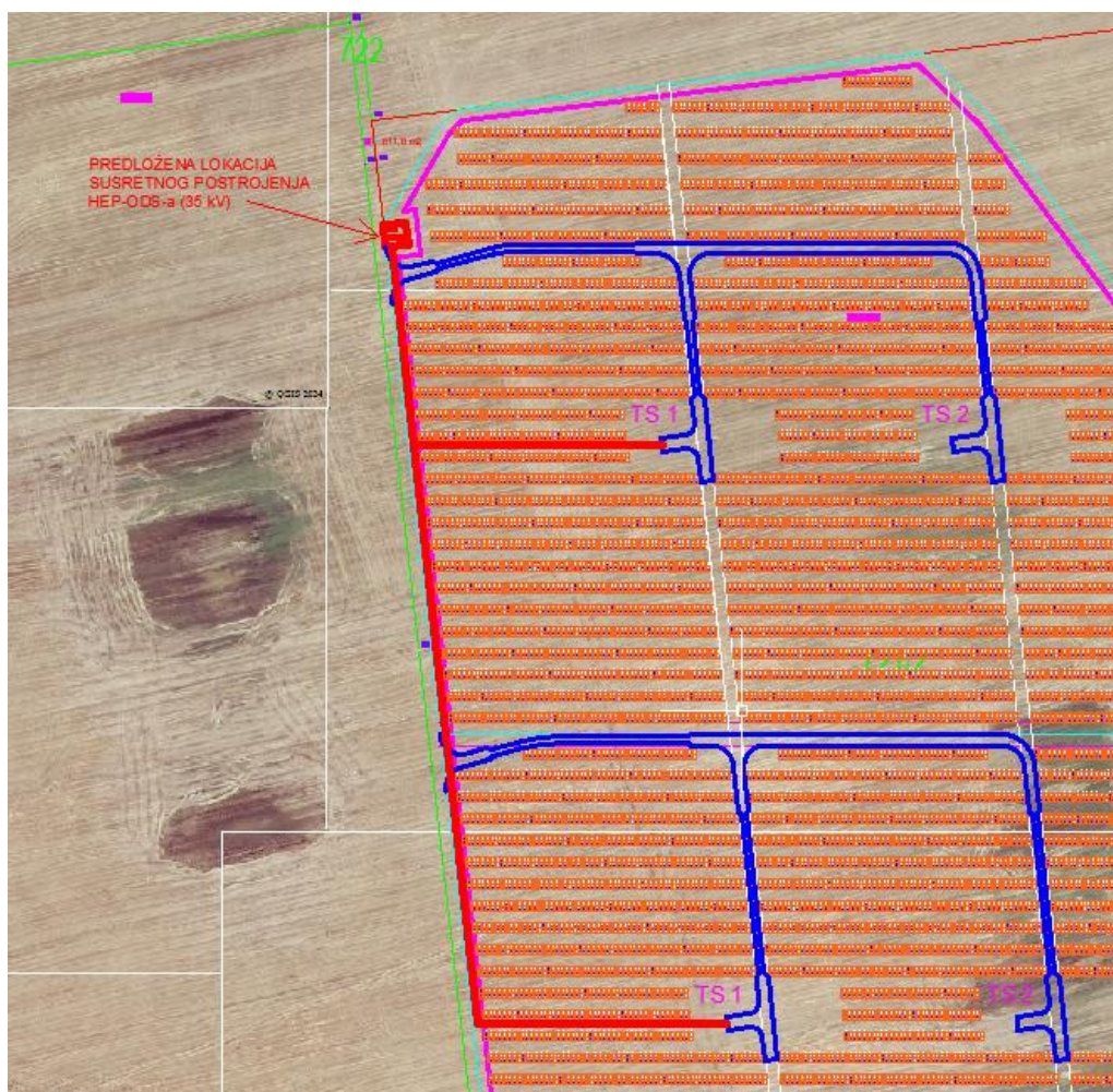
Slika 4. Prijedlog priključenja sunčanih elektrana na elektroenergetsku mrežu (prijedlog trase kabela – crvena linija)
