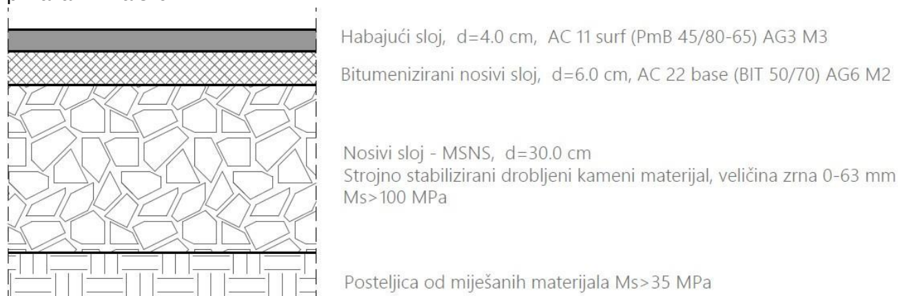
Slika 1. 1 - 4 Slojevi kolničke konstrukcije (izvor. Idejni projekt)
