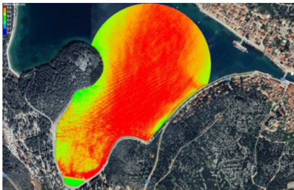
Slika 2.21 Polje značajnih valnih visina za postojeće stanje i simulaciju A1 s parametrima vala iz smjera NNE (22,5°) za 5-godišnji povratni period ( H_s=0,61 m; T_p=3,18 s)
