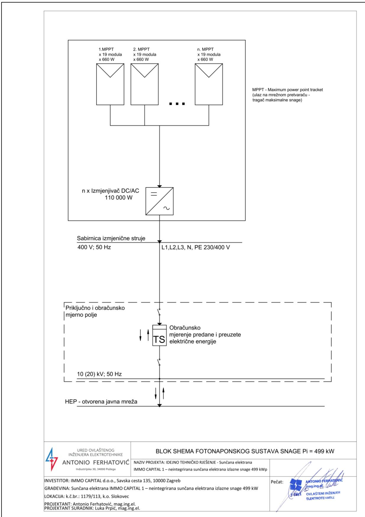
Slika 5. Blok shema razvoda pretvarača
