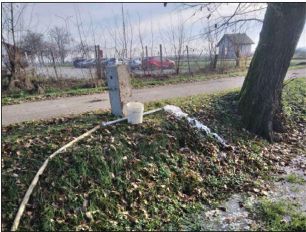
**Slika 12. Prikaz pokusnog crpljenja zdenca Z-2 (Izvor: Hidrogeološki elaborat, Vodovod-hidrogeološki radovi d.o.o.)**
