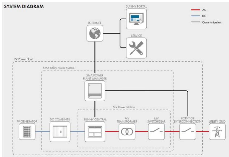
Slika 1.1.3.1. Principijelna shema sunčane elektrane priključene na elektroenergetsku mrežu (Idejno rješenje)
