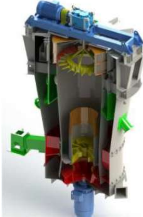
Slika 1.1/2 – Postojeći separatori u mlinici cementa
