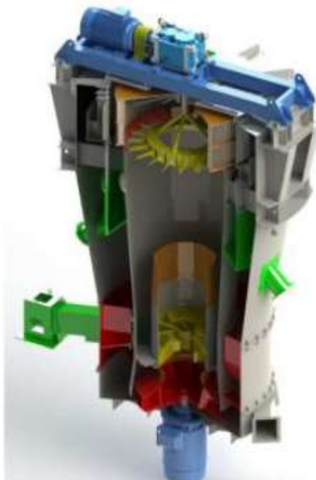
Slika 1.1/2 – Postojeći separatori u mlinici cementa
