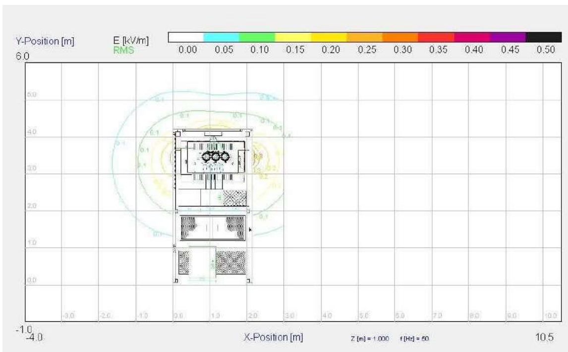
Slika 1.9.2. Prikaz proračuna električno polje DTS za napon do 21kV na visini 1m (krivulje crne boje su granica od 0,5kV/m)
