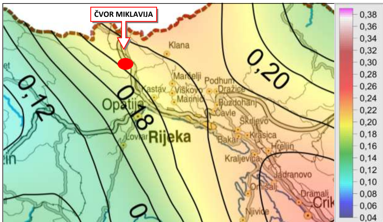
Slika 9.6.2. Poredbeno vršno ubrzanje tla tipa A s vjerojatnosti premašaja 10% u 50 godina (povratno razdoblje 475 godina) izraženo u jedinicama gravitacijskog ubrzanja, g
