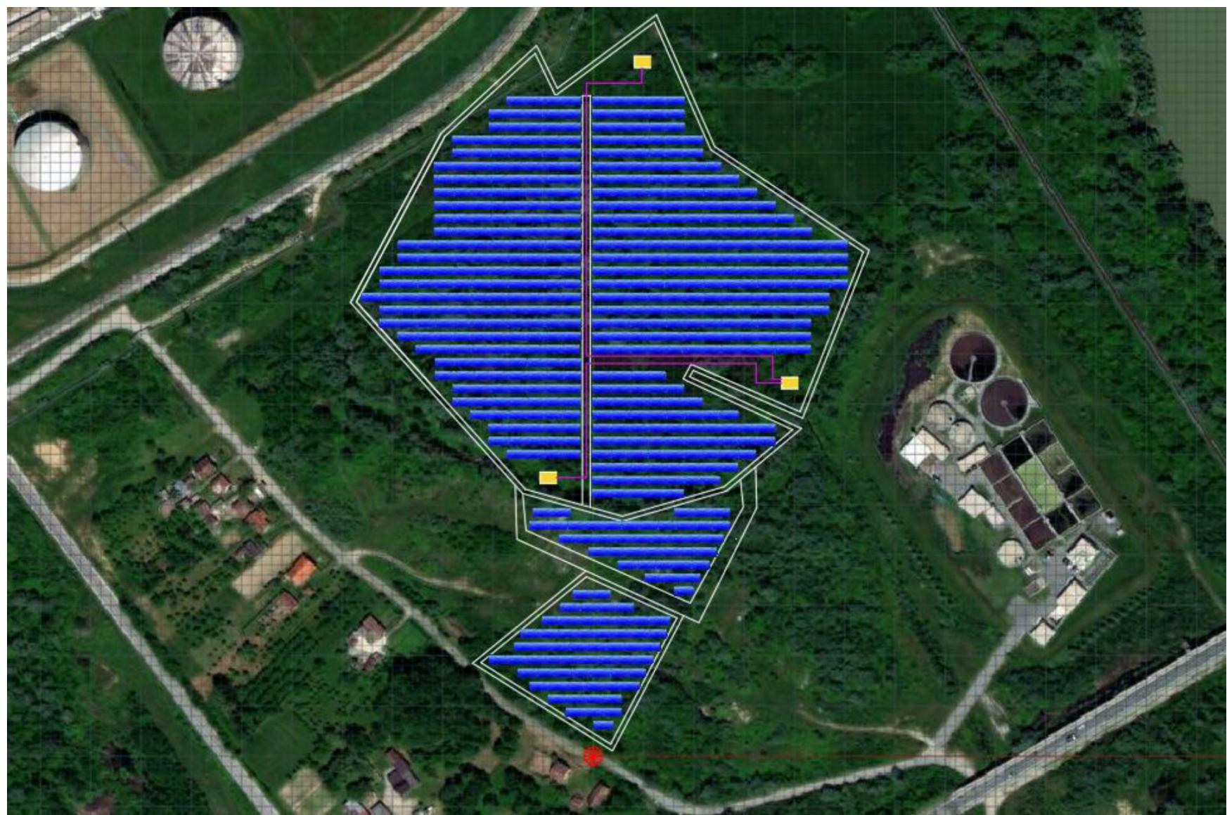
**Slika 7.** Preliminaran prikaz razmještaja FN modula, internih komunikacija i internih trafostanica na promatranoj parceli – s podlogom satelitske snimke. Izvor: Idejno rješenje. Elektrotehnički projekt, broj projekta: 127-23-01-TD-23; Izradio: Grid ONE d.o.o., listopad 2023.
