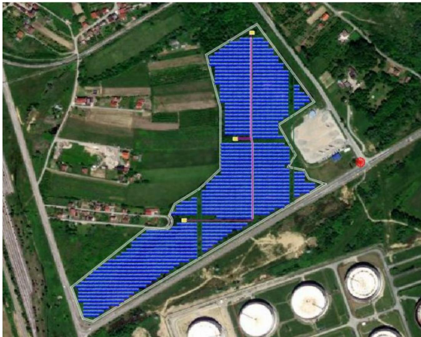
**Slika 4.** Preliminaran prikaz razmještaja FN modula, internih komunikacija i internih trafostanica na promatranoj parceli – s podlogom satelitske snimke. Izvor: Idejno rješenje. Elektrotehnički projekt, broj projekta: 123-23-01-TD-23; Izradio: Grid ONE d.o.o., listopad 2023.
