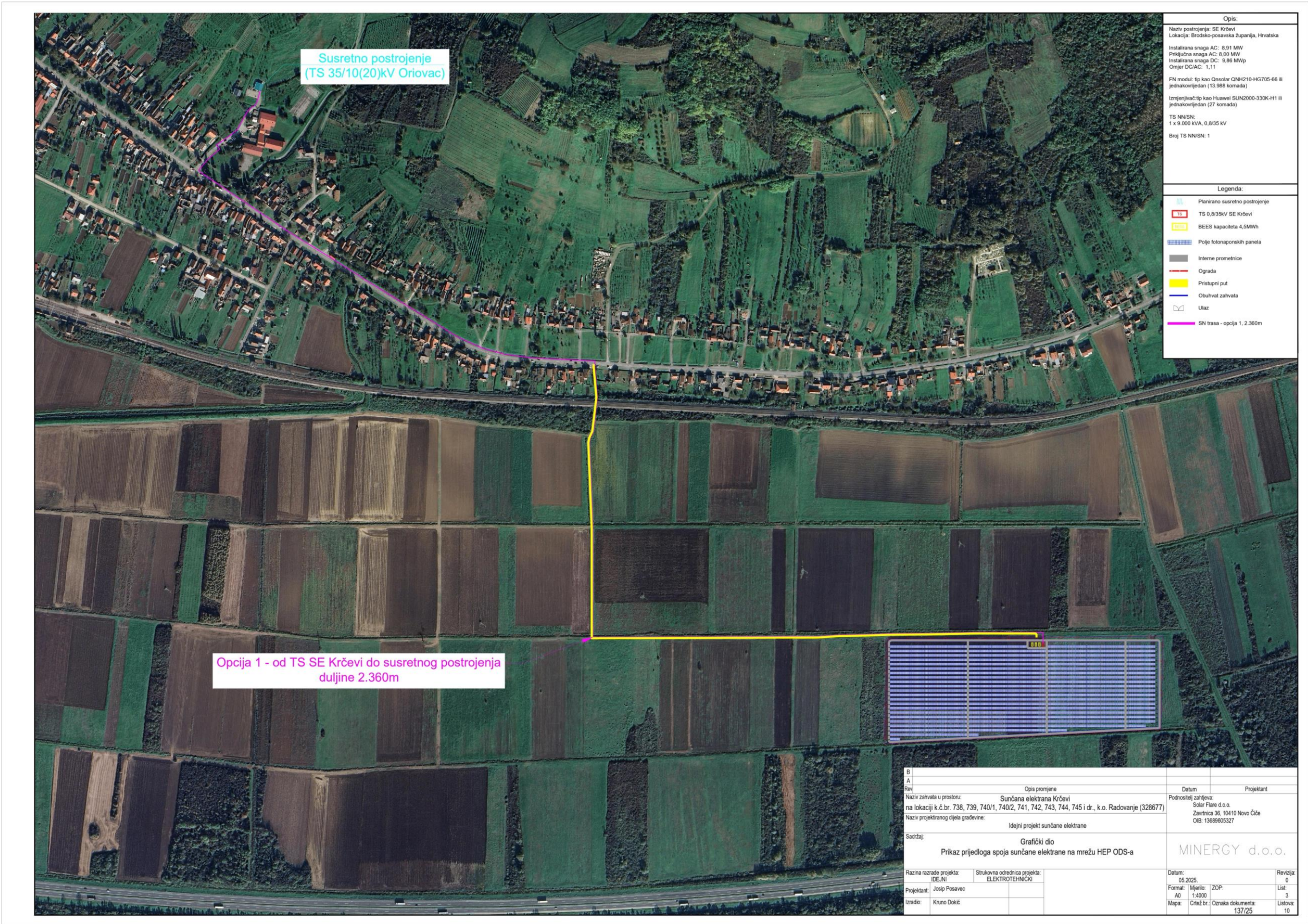
Prilog 2. Prikaz priključka SE Krčevi na elektroenergetski sustav
