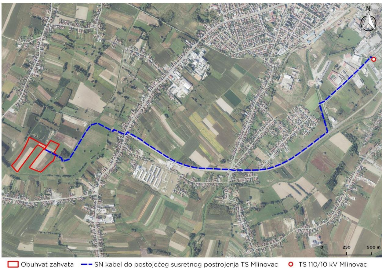
Obuhvat zahvata — SN kabel do postojećeg susretnog postrojenja TS Mlinovac ● TS 110/10 kV Mlinovac
