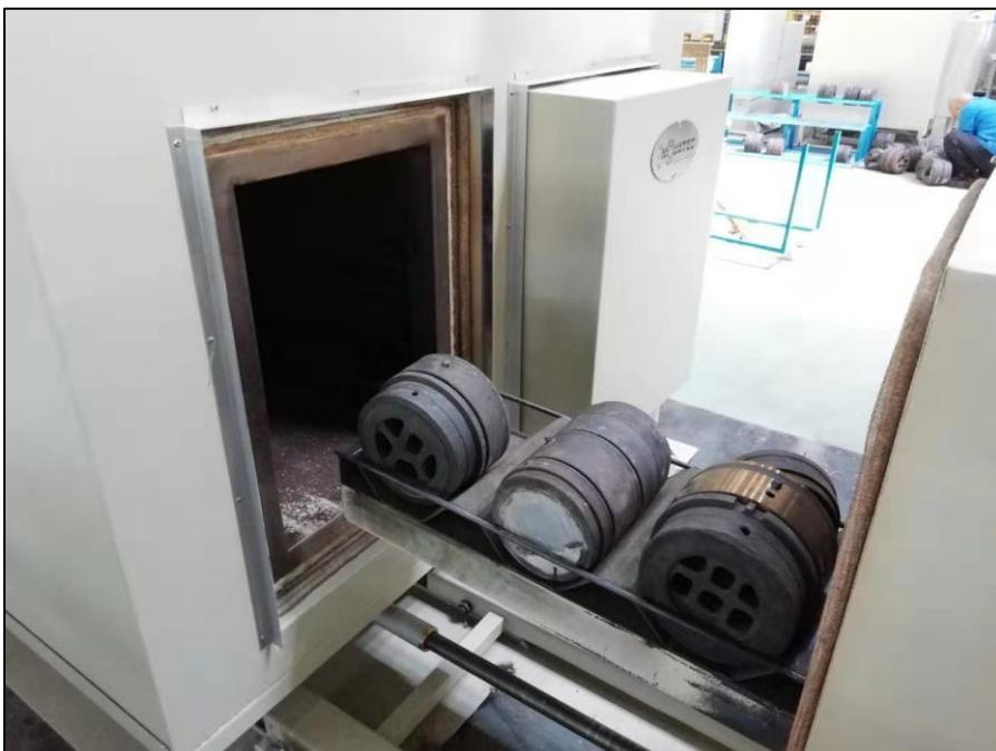
Slika 9. Peć za zagrijavanje alata s nosače
