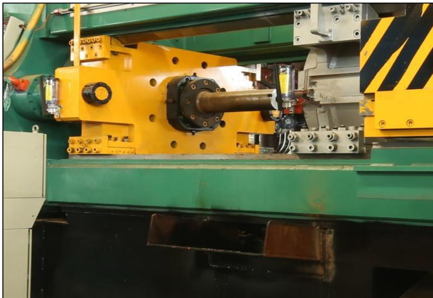
Slika 8. Prikaz sustava ubacivanja aluminijskih trupca u prešu
