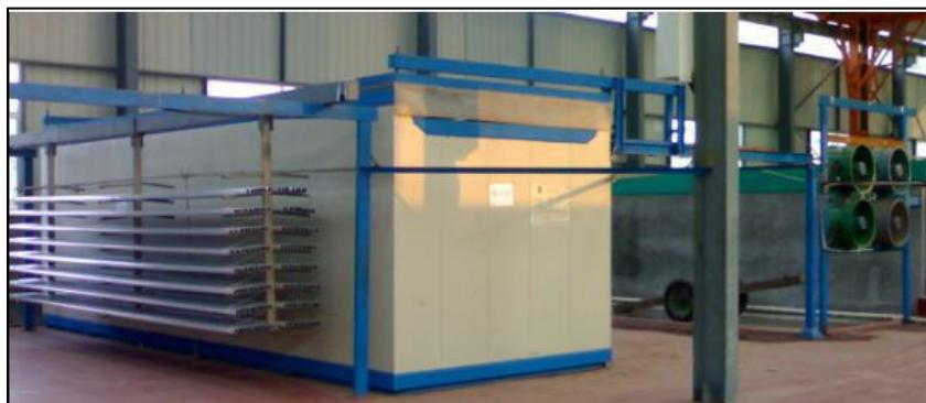
Slika 16. Komora za sušenje profila nakon odmašćivanja
