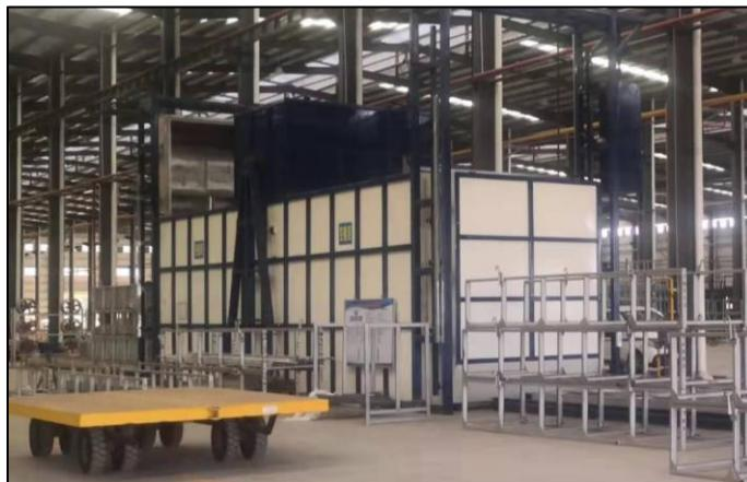
Slika 14. Peć za toplinsku obradu profila
