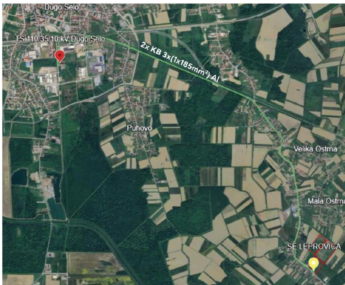
Grafički prikaz 3-3: Prikaz priključka na satelitskoj podlozi – varijanta priključka 1 (Izvor: Energetski institut Hrvoje Požar | Zagreb | 31. siječnja 2025. ANALIZA MOGUĆNOSTI PRIKLJUČENJA SE LEPROVICA)
