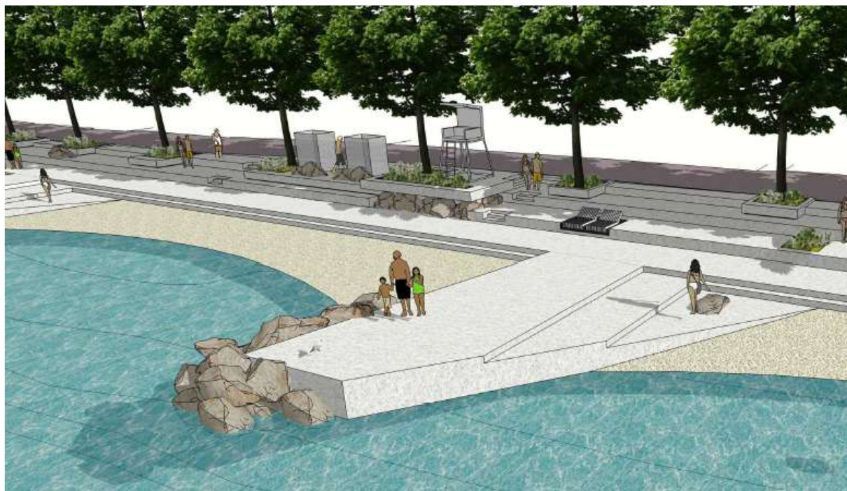
Slika 8.3. 3-D prikaz kamene školjere na glavi zaštitnog gata/pera (izvor: Idejni projekt, NFO d.o.o, travanj 2018)
