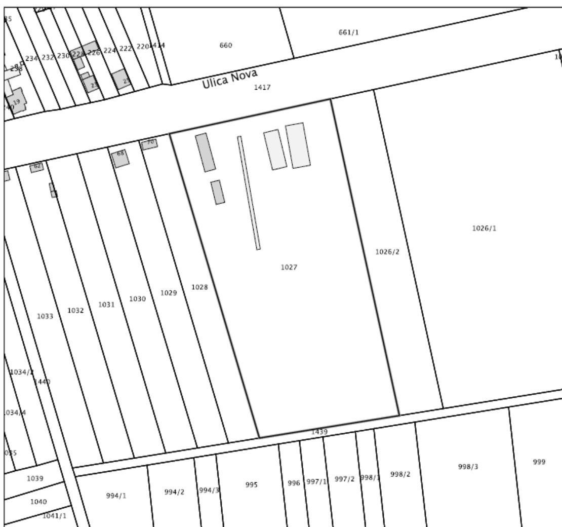
Površina čestice planiranog zahvata je 20.007 m<sup>2</sup>. Površina koju će zauzimati sunčana elektrana iznosi 7596 m<sup>2</sup>. Površina koju će zauzimati baterijski sustav iznosi 32 m<sup>2</sup>. Ukupna izgrađenost zemljišta iznosi 53,99%. Pristup građevini bit će omogućen sa sjeverne strane čestice.
